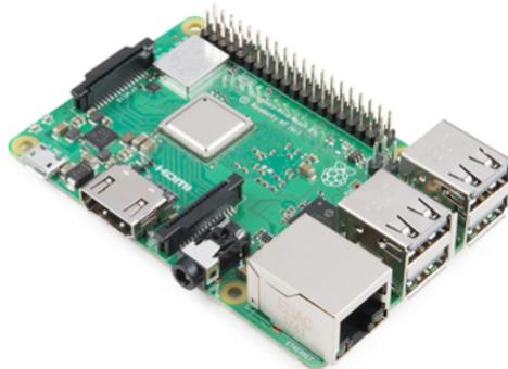
**Figure 1.** Raspberry Pi 3 B plus
